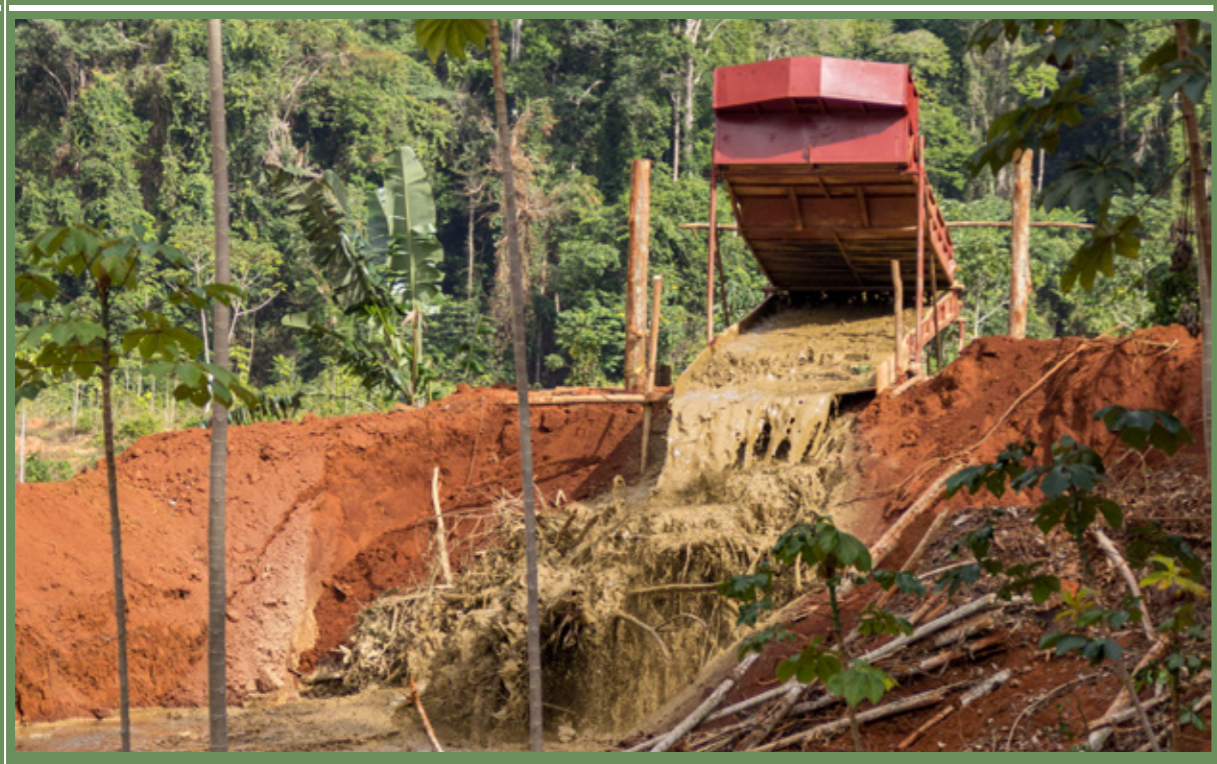
เหมืองมารูดี รูปูบูมีใต้ กายานา เครื่องสูบน้ำที่ไม่บำบัดน้ำลงสู่หลุมเหมืองร้าง เครดิต: วิกิ บราวน์
